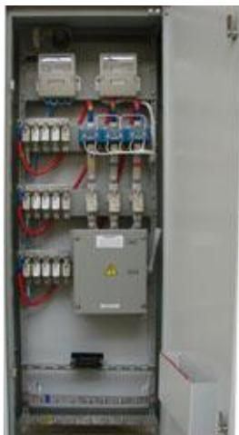
Устройства вводно-распределительные УВР 8504 для жилых и общественных зданий предназначены для приема, распределения и учета электроэнергии напряжением 380/220 В в сетях трехфазного переменного тока частотой 50 Гц, для защиты линий при коротких замыканиях и перегрузках, а также для нечастых оперативных включений и отключений, согласно ГОСТ Р 51321.1-2007; ГОСТ Р 51732-2001.
