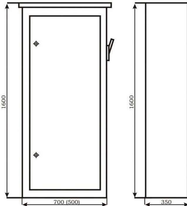
Предназначен для приема и распределения электрической энергии и применяются в силовых и осветительных цепях трехфазного переменного тока напряжением до 380В с глухозаземленной нейтралью трехфазного переменного тока частотой 50Гц с защитой отходящих линий предохранителями ПН2-100 (ППН33 до 100А), ПН2-250 (ППН35 до 250А), ПН2-400 (ППН37 до 400А)
